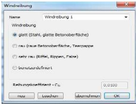
Windreibung erzeugt horizontale flächenparallele Flächenlasten auf den Windoberflächen. Nur bei in Windrichtung „langen“ Gebäuden und je nach Oberflächenrauigkeit kann sie erkennbaren Einfluss auf die Beanspruchungen nehmen.
