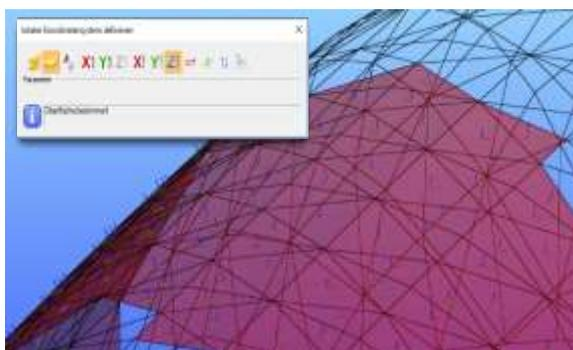
Die lokalen z-Achsen der Koordinatensysteme aller individuell im Raum orientierten Lastübertragungsflächen müssen für eine korrekte Lastplatzierung nach außen zeigen. Die links gelb unterlegten Icons erlauben das gleichzeitige Setzen der lokalen Koordinatenachsen (hier: z-Achse) aller Einzelflächen, indem auf einen inneren Punkt der Struktur geklickt wird.
