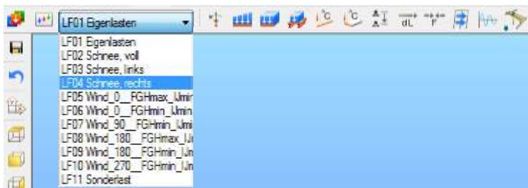
Zur korrekten Erstellung einer Last ist **vorweg** mit dem Klappmenü die Zugehörigkeit zu einem Lastfall zu erklären.
