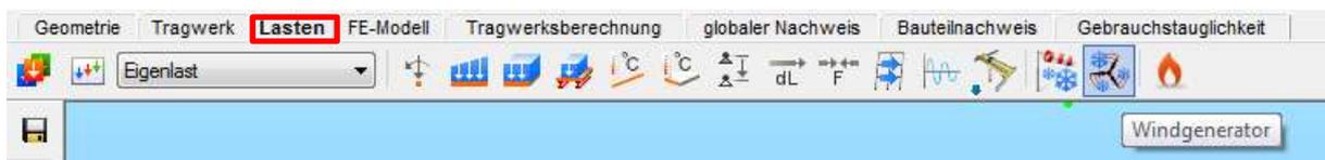
Diese Funktion berechnet nicht nur die Flächenbereiche A bis J aller Windlastfälle, sondern auch die Schneelastfälle basierend auf den bereits formulierten (s.o.) Wind- und Schneelastparametern.
