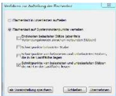
**Verteilung der Flächenlast mit Hilfe der Systemknotenpunkte mit folgenden Regeln:**
