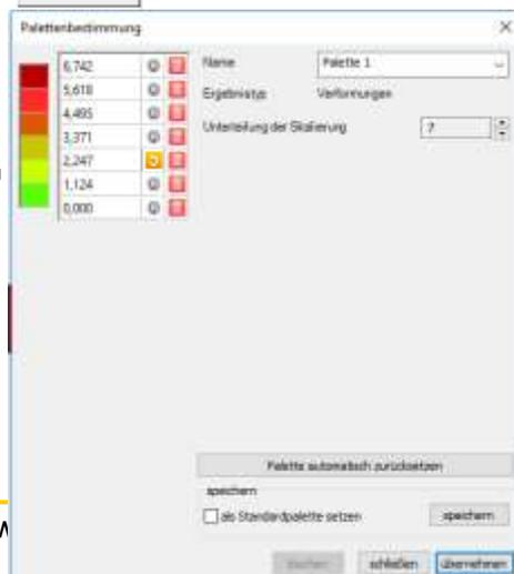
Im numerischen Feld “Unterteilung der Skalierung” kann mit den Pfeil-Schaltern (↕) die Anzahl der Skalierungen verändert werden. Mit dem **Löschen-Icon** (🗑️) kann die betreffende Skalierungszeile gelöscht werden.
