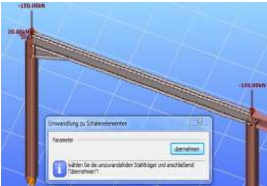
Mit der Funktion „**TRANSFORMIERE TRÄGER ZU SCHALENELEMENTEN**“ (🔲) können Träger auf Knopfdruck ohne jeden Aufwand zu ebenen Schalenelementen ummodelliert werden.
