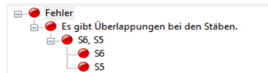
Durch Anklicken eines der Objektamen und Betätigung des **AUSWÄHLEN**-Schalters wird das betreffende Element auch in der Modellgrafik hervorgehoben. Durch gleichzeitiges Drücken der **SHIFT** oder **STRG**-Taste und Anklicken von Objektamen können mehrere Objekte hervorgehoben werden.
