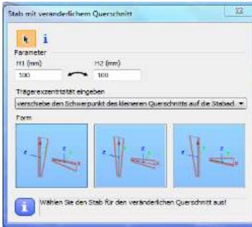
Mit der Funktion „**VERÄNDERLICHER QUERSCHNITT**“ (
