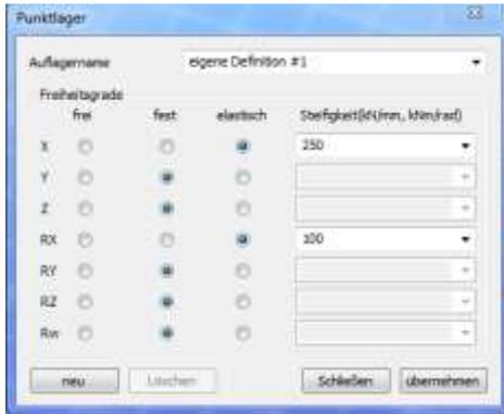
Mit dem **“MEHR”** (☰)-Icon und dem **“NEU”**-Schalter können neue Lagerungsbedingungen erstellt werden. Die 7 Freiheitsgrade können individuell einzeln als frei, fest oder elastisch definiert werden. Bei elastischer Lagerung (Feder) sind Eingaben in kN/mm (Wegfeder) oder kNm/rad (Drehfeder) erforderlich.
