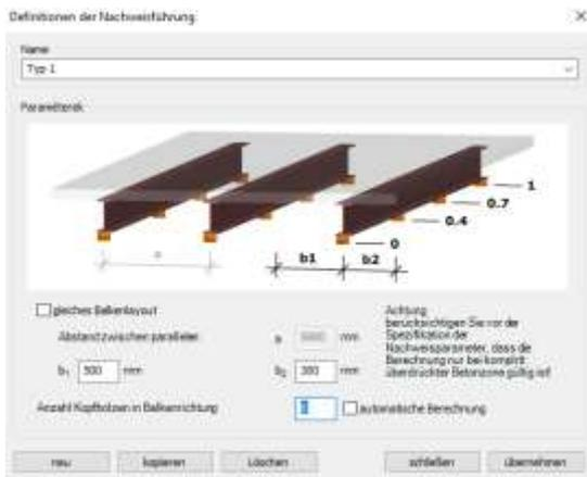
Im Fenster der **NACHWEISFÜHRUNG** werden der Abstand  $a$  der parallelen Träger (oder die Länge der beiden Auskragungen  $b_1$  und  $b_2$ ), die Anzahl der Kopfbolzen (bzw. Wahl der automatischen Bestimmung).
