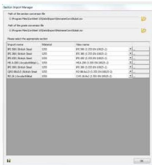
Mit Klick auf **OK** wird der Import gestartet und der **QUERSCHNITTSIMPORT MANAGER** erscheint. Man kann dort die Übersetzungsdatei für die Materialien und Querschnitte wählen/ändern oder die Materialien und Querschnitte händisch ändern.
