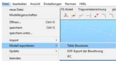
Für den Export eines **CS** -Strukturmodells zu Tekla Structures müssen unbedingt sowohl Tekla als auch **CS** parallel geöffnet sein. Innerhalb von Tekla Structure ist ein Modell zu öffnen. Dann wählen Sie aus dem **DATEI**-Menü **MODELL EXPORTIEREN** und anschließend **TEKLA STRUCTURES**.
