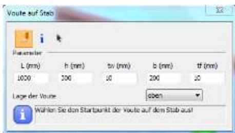
Im Dialogfenster sind die Voutenlänge ( $L$ ), Maximalhöhe ( $h$ ), Stegdicke ( $t_w$ ), Flanschbreite ( $b$ ) und -dicke ( $t_f$ ) zu spezifizieren.
