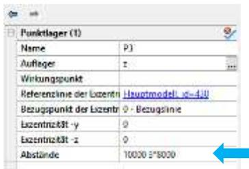
Die Lage der mit der Option **MEHRFACHSTÜTZUNG** erstellten Stützungen können später als ein Objekt über „Abstände“ verändert werden
