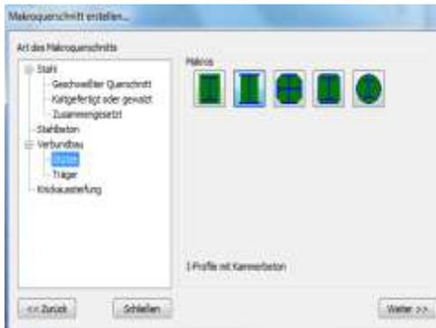
Über „**MAKROQUERSCHNITT**“ stehen fünf Querschnittstypen zur Verfügung:
