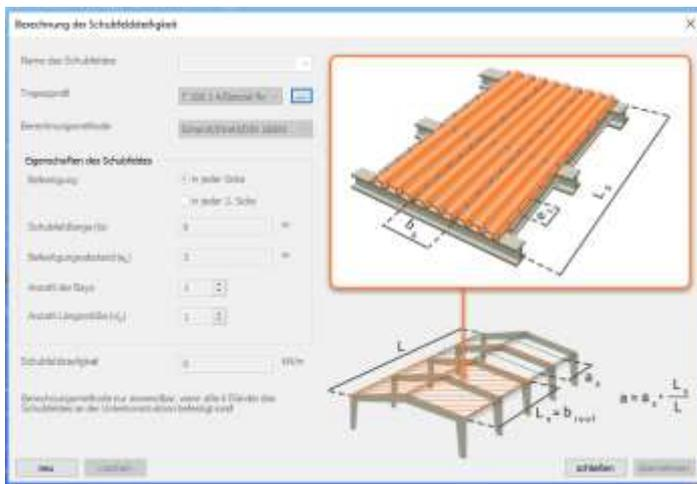
Mit dem Schalter in Bereich (#1) des ersten Schubfelddialogs (s.o.) öffnet sich der Dialog der „**BERECHNUNG DER SCHUBFELDSTEIFIGKEIT**“. Ein neues Schubfeld wird hier mit dem **„NEU“**-Schalter gestartet.
