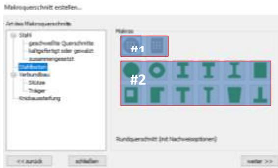
Stahlbeton-Querschnitte für Träger werden im **MAKRODIALOG** erstellt. Zwei Arten von Querschnitten stehen zur Verfügung:
