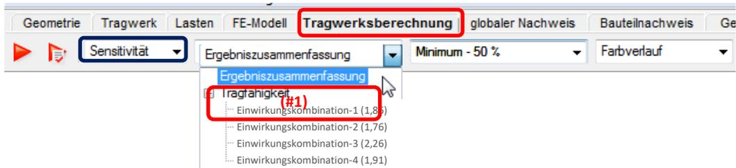
Rechts daneben kann man mit der Klappbox „**Minimum**“ (des MFR's) einen Minimalwert festlegen, oberhalb dem erst die Eigenwerte angezeigt werden. Die Einstellung des minimalen MFR's wird zu 50%-70% wird empfohlen.
