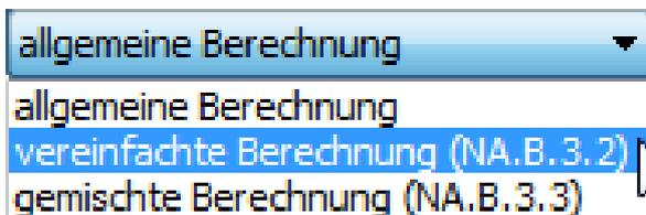
(Nur) im Falle des deutschen NA's kann mittels Drop-Down-Menü (#0) eine von drei Berechnungsmethoden benutzt werden, die **nicht zu identischen Winddrücken** führen:
